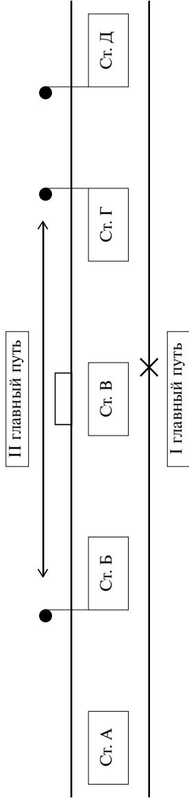
**Рис. 1.3.** Схема расстановки переносных сигналов остановки при организации двухстороннего движения на участке между станциями Б и Г. Путь приема в неправильном направлении на ст. Г со стороны перегона, прилегающего в правильном направлении, не огражден светофором (или огражден входным светофором автоматического действия). Закрывается участок от ст. Б до ст. Д.
