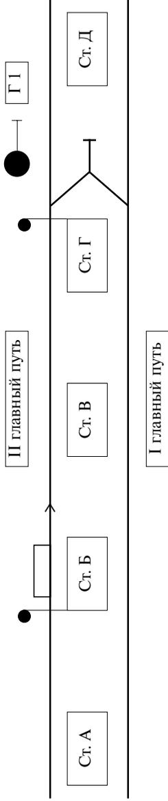
Поезд следует в неправильном направлении со ст. Б на ст. Г, участок от ст. Б до ст. Г закрыт.
