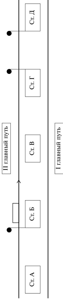
Поезд следует в неправильном направлении со ст. Б на ст. Г, участок от ст. Б до ст. Д закрыт.
