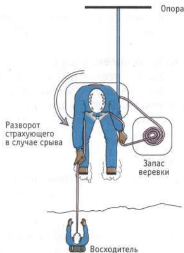
Неправильное положение страхующего при использовании обвязки с передней точкой крепления веревки
