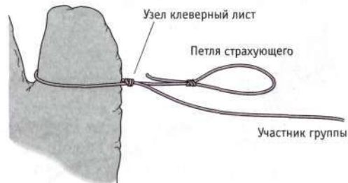
4. Петля сделана на нагруженном конце веревки и накинута на выступ
