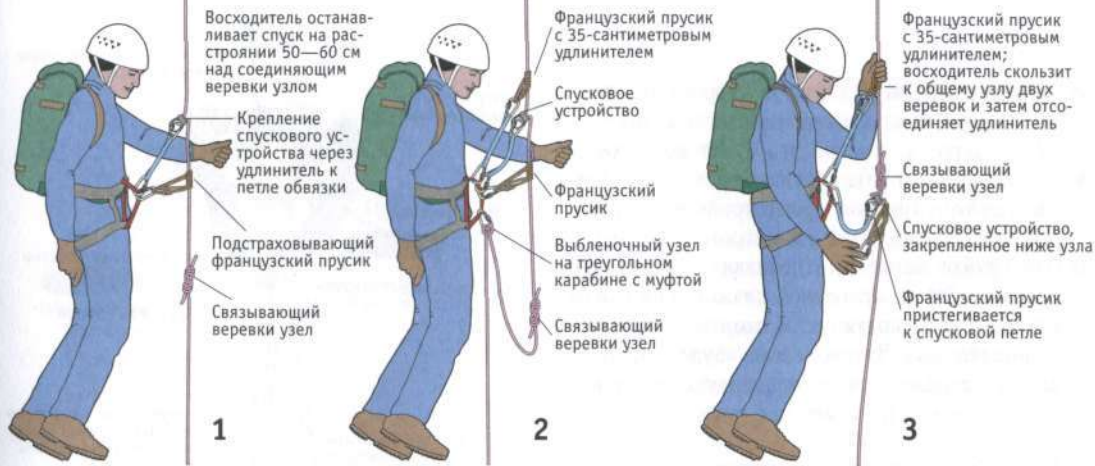
Переход через узел при самостоятельном спуске
