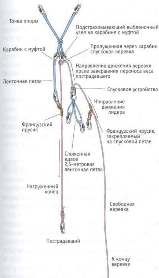
Переключение на спуск противовесом: точка опоры в пределах досягаемости
