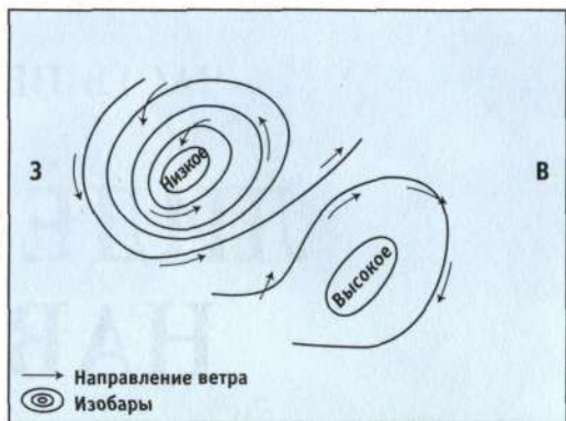
Воздушные потоки движутся вокруг и внутрь в области низкого давления; вокруг и вне — в области высокого давления
