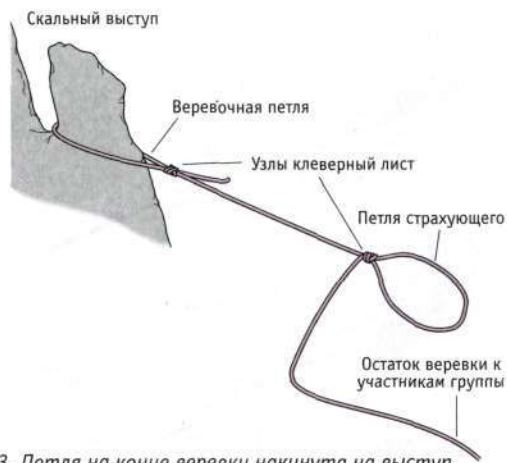
3. Петля на конце веревки накинута на выступ, а поясная петля — ниже на веревке
